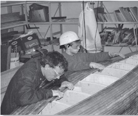
Täglich werden nun Zedernleisten aufgeplankt und verklebt. Die Verklebungen müssen im Ruhezustand abbinden können. In der Zwischenzeit sucht die Gruppe passende Leisten für die nächste Klebeeinheit zusammen.
