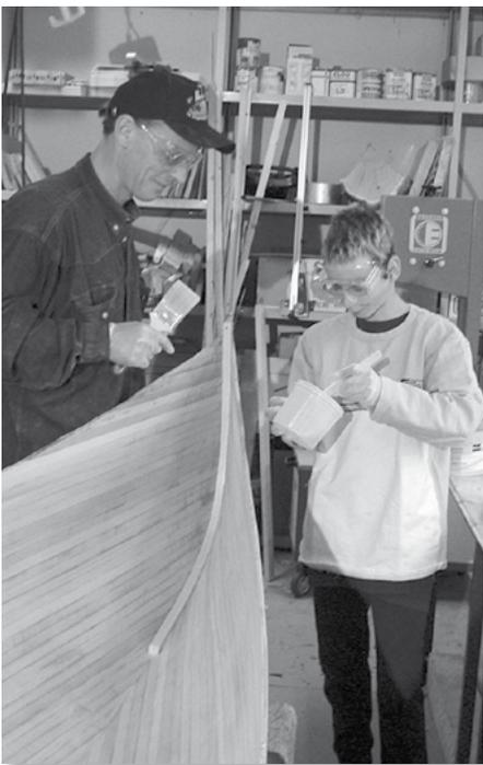
Ein paar Tage später kann die Bootshülle nun von der Form genommen werden. Es wird die Rumpffinnenseite zum Beschichten vorbereitet. Die Arbeitsgänge sind vergleichbar mit den Arbeiten an der Rumpfaußenseite.
