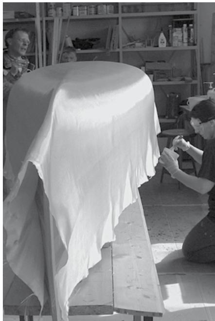
Das Ergebnis nach 120 Arbeitsstunden: Der Bootsrumf ist nun geschlossen. Nun wird der Kiel angepasst und das komplette Kanu außen geschliffen. Zu den zeitintensivsten Arbeiten zählen die Schleifarbeiten.
