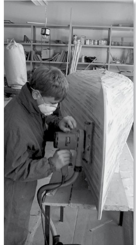
Um den Bootsrumf gegen Stöße und Steine zu schützen, werden mehrere Lagen Harz mit Glasgewebe aufgetragen. Das transparente Harz lässt die Schönheit und Struktur des Holzes hell leuchten, es schließt aber auch jeden Fehler, jede Delle, jedes Pinselhaar für immer und ewig sichtbar mit ein.
