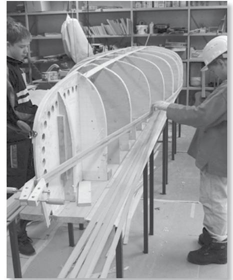
Vor dem Anbringen der ersten Leiste wird die Form des Rumpfes auf fließende Linien ohne Ecken und Kanten überprüft. Nun kann die erste, die sogenannte Schergangsstange angebracht werden.
