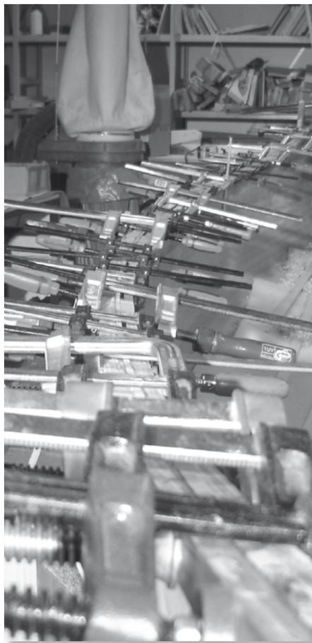
Das Bild zeigt das Anbringen der Weger (Scheuerleisten) am Kanu. Diese Leisten sorgen für die Formhaltung des Kanus. Sie dienen zum einen zur Stabilisierung des Bootsrumpfes, damit sich dieser bei Belastung nicht verdreht. Zum anderen dient der Weger zum Schutz vor Beschädigung. Alle Einbauten wie z.B. Sitze oder das Tragejoch werden in den darauf folgenden Wochen von der Gruppe in Handarbeit aus Esche gefertigt.
